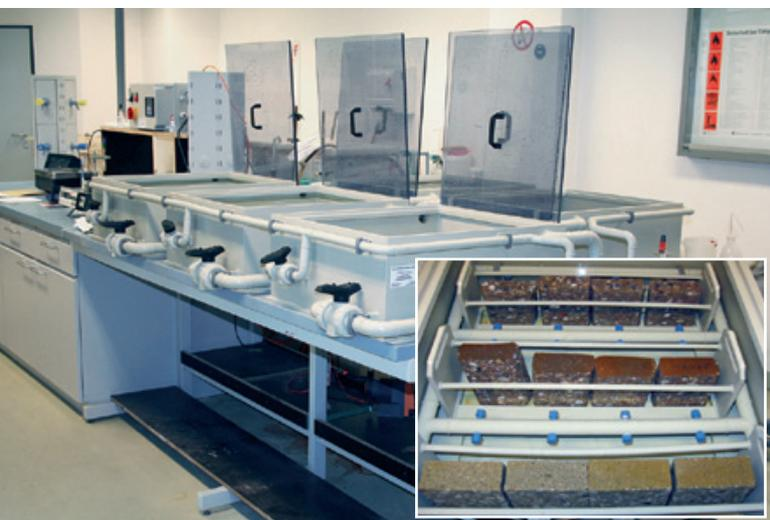
Bild 2: Prüfstand zur Bestimmung des Säurewiderstands von Beton; Übersicht und Detail
