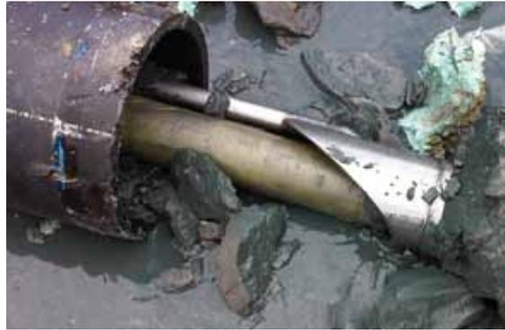
↑ Das freigelegte Altkabel nach Beendigung des Überbohrungsvorgangs.
